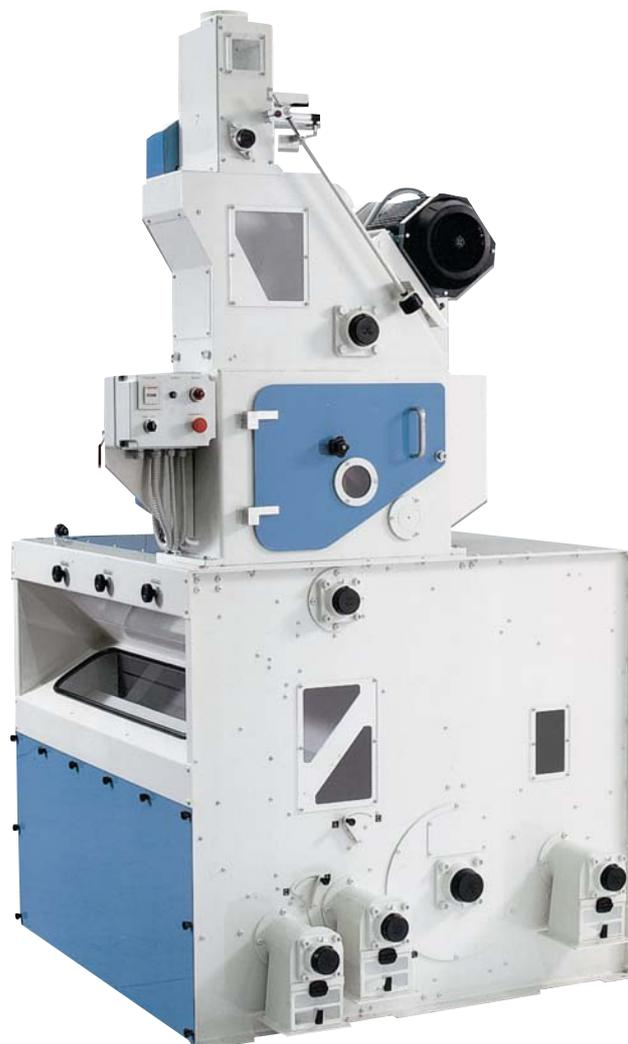
La sbramatura, processo con il quale avviene il distacco di glume e glumelle dal risone (paddy rice) ottenibile attraverso l'azione di sfregamento attuata da una coppia di rulli gommati in rotazione con velocità diverse. Golfetto Sangati ha ideato e realizzato una macchina in grado di fornire ottime performance di lavorazione (SBR-SD 25)
