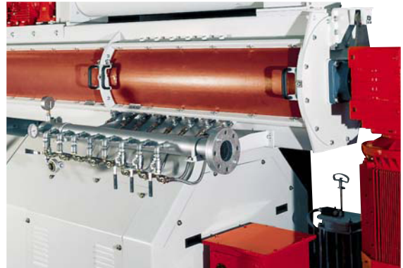
Collettore di immissione vapore. Collector for steam injection.
