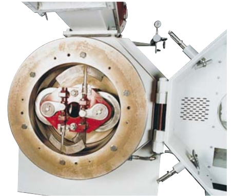
Gruppo rulli e filiera. Dettaglio del sistema manuale regolazione rulli e coltelli distributori del prodotto all'interno della filiera.
