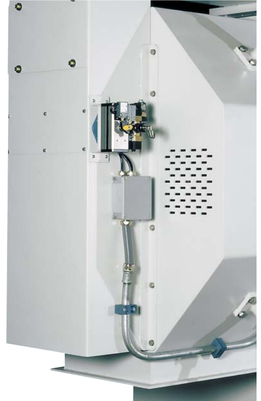
Valvola deviatrice pneumatica per l'esclusione rapida dell'alimentazione.
