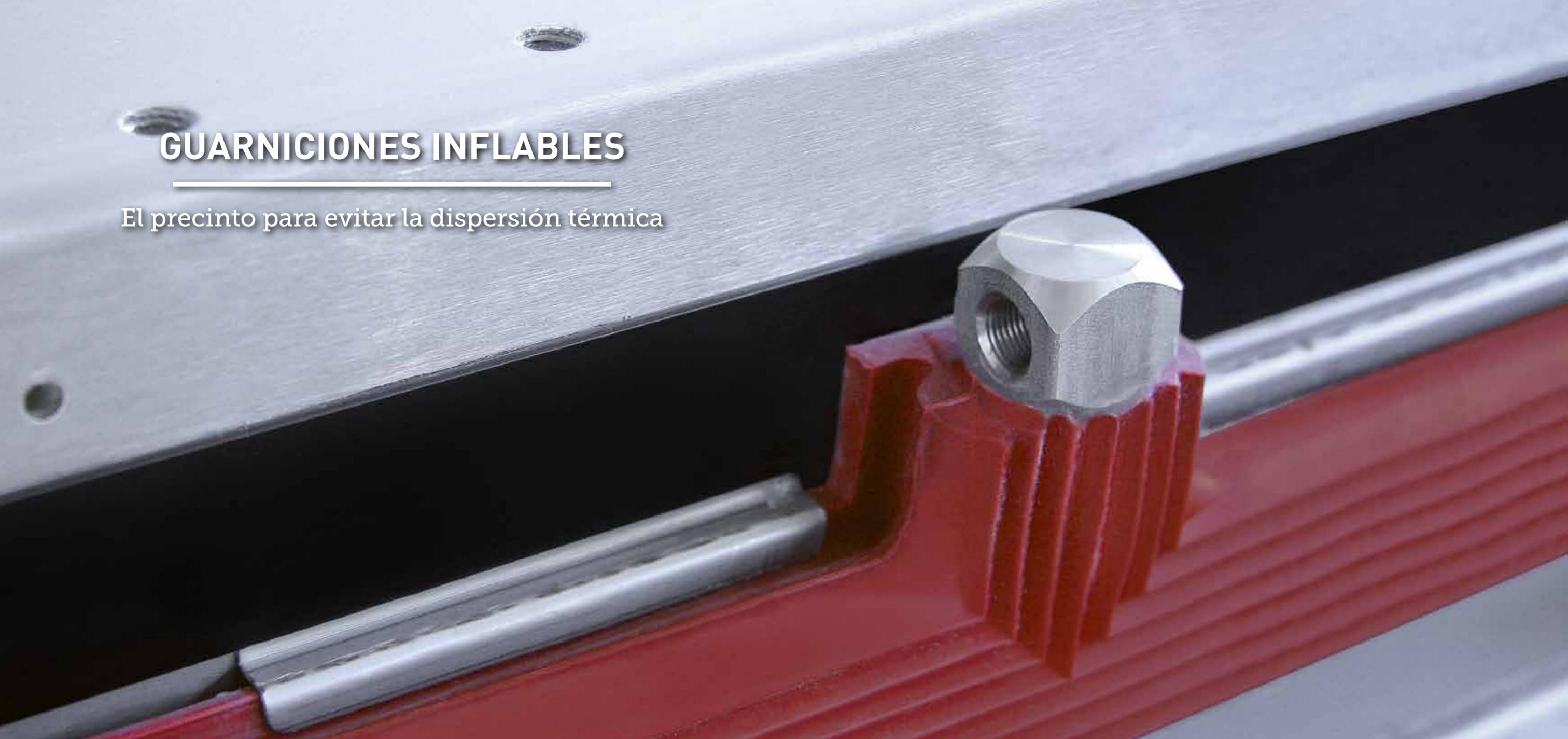
Se realizan con un componente especial a base de VMQ que después de un proceso de vulcanización a 200°C adquiere una excelente resistencia a las altas temperaturas, a la humedad y a la laceración. La cámara interna se presuriza con aire a 0,8 bar
